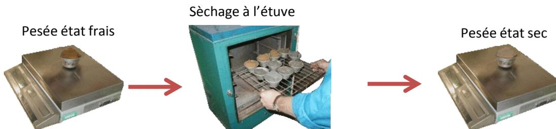
$$W\% = \frac{m_w \text{ masse d'eau évaporée}}{m_d \text{ masse matériaux sec}} \times 100$$
